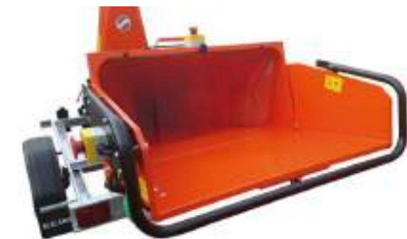
Trémie d'alimentation : 1200 x 430 mm pour matériaux volumineux. Conforme à la réglementation
